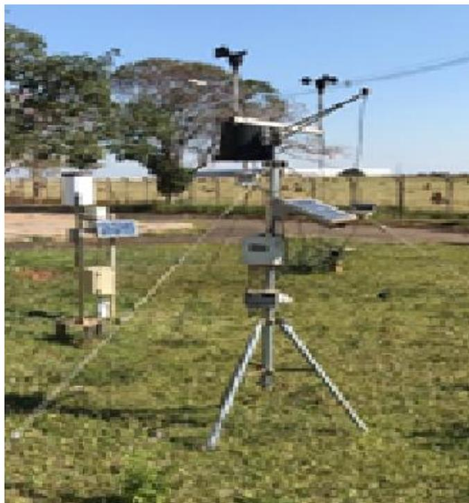
Figura 3: Vista geral da Estação Automática na frente e o protótipo ao fundo, durante os testes no Campus da Fatec Tatuí.
