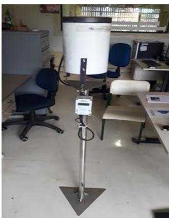
Figura 1: Foto do pluviômetro na sala de operaes do SIMET na Fatec Tatu
